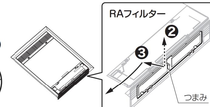
交換後、分電盤のブレーカーを入れ、運転をして異常音がしないか、各給気グリルから風が正常に出ているか、確認してください。
